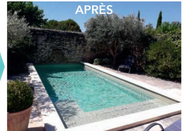
Rénovation d'une piscine de 8,00M x 3,50M, avec remplacement des skimmers, réfection arase, reprise d'enduit, remplacement des margelles, création d'un escalier, pose d'un revêtement en résine polyester, d'un volet roulant caillebotis immergé, sécurisé par « auto-fix » (pas de crochets apparents)
