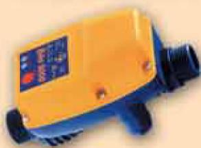
Surpresseur électrique horizontal, permet d'automatiser la mise en marche et l'arrêt d'un pompe monophasée, relatifs, respectivement, à la baisse de pression, (ouverture des robinets) et à l'interruption du débit dans l'installation. (fermeture des robinets). Protection contre la marche à sec. Courant maxi 12A. Ne pas utiliser pour le pompage d'eaux chargées en sédiments, ex : eau de canal
