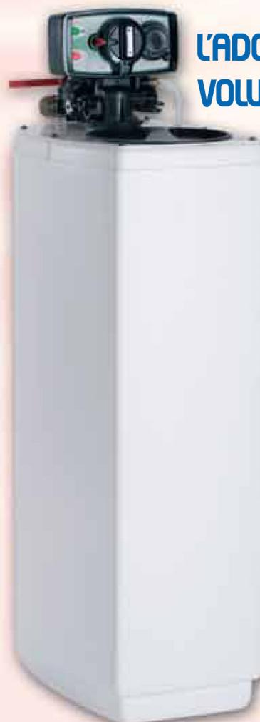
Il élimine par échange ionique sur résines minérales le calcaire de l'eau et protège les robinetteries et appareils ménagers. Avec cet appareil vous disposez en permanence d'une eau plus douce et de meilleure qualité. Adoucisseur d'eau équipé d'une vanne volumétrique automatique et d'un bypass. Existe en 12, 20 et 30 litres
